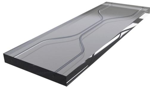
Рисунок 11: Волоконный светоделитель на основе интегрального чипа
