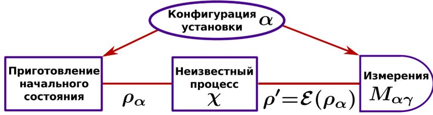
Рисунок 2: Принципиальная схема томографии квантовых процессов
